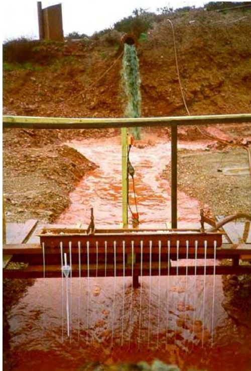
Abb. 11: Dosierungssystem für die Carbonatzugabe / Wheal Jane Mine Cornwall / UK aus ANONYM K (O.J.)
