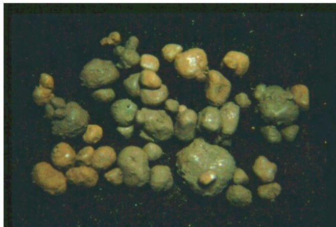
Abb. 51: Als Filtermaterial beim Projekt GreiFMan der Uni Karlsruhe verwendete Filterkiese aus der Trinkwasseraufbereitung aus ANONYM P (O.J.)
