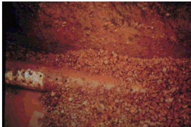
Abb. 30: Durch Hydroxide völlig verschlossene Zulaufleitung und Carbonat- schüttung eines ALD-Systems aus SKOUSEN (O.J.)
