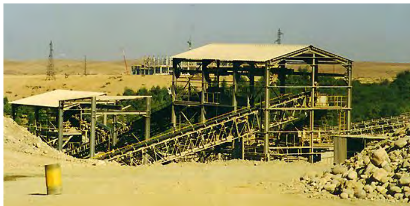
Abb. 17: Anlage für das "paste backfill"-Verfahren / HAJARS Mine / Atlas Marocco aus ANONYM O (O.J.)
